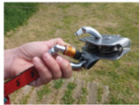
Ein Haken und ein halbautomatischer Karabiner mit dynamischem Sicherungsmaterial und rotem Farbcode. Eine Seilrolle mit statischem Sicherungsmaterial und halbautomatischem Karabiner. Zum Öffnen dieses Karabiners den orangefarbenen Verschluss nach unten ziehen und den Karabiner nach innen aufdrücken.
