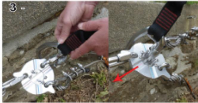
3 - An Kreuzungen heben Sie einfach die kleine mittlere Richtungsscheibe an und drehen Sie diese um eine viertel Umdrehung in die gewünschte Position.
