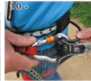
10 - Sie können nun die Seilrolle aushängen und diese an einer der Materialschlaufen befestigen, die sich auf beiden Seiten des Klettergurts befinden.
