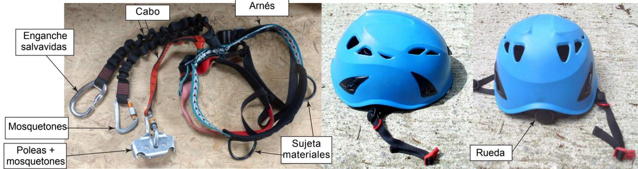
Un arnés equipado de 3 cabos y una polea. Un casco con rueda reguladora.
