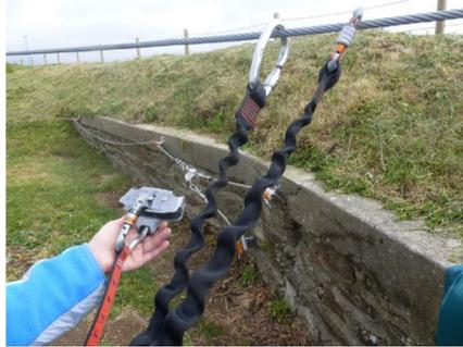
Los cabos dinámicos con un color rojo provisto de un enganche y mosquetón semi automáticos. El cabo estático con una polea y un mosquetón semi automático. Para la apertura de este mosquetón hay que bajar la anilla naranja y empujar sobre el dedo.
