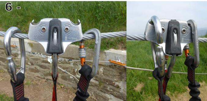
Pongo mi polea sobre el cable delante del enganche y añado el mosquetón delante de mi polea. Verifico que mi polea rueda correctamente y posiciono mi crochet y el mosquetón por encima de la polea.
