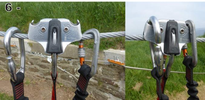
6 - Je mets ma poulie sur le câble devant mon crochet et je rajoute mon mousqueton devant ma poulie. Je vérifie que ma poulie roule bien puis je positionne mon crochet et mon mousqueton sur le dessus de la poulie.
