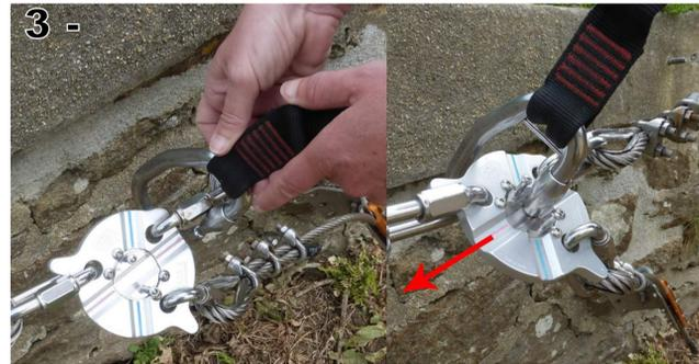
3 - Pour les choix de direction, il suffit de soulever le petit disque central et de le tourner d'un quart de tour pour le positionner dans la direction souhaitée.
