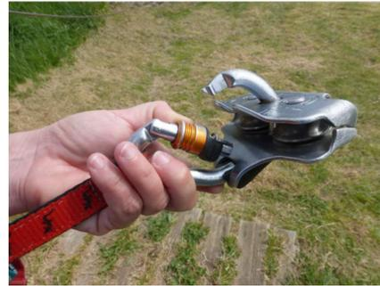
Deux longes dynamiques avec un code couleur rouge munies d'un crochet et d'un mousqueton semi-automatique. Une longe statique avec une poulie et mousqueton semi-automatique. Pour l'ouverture de ce mousqueton il faut descendre la bague orange et pousser sur le doigt.
