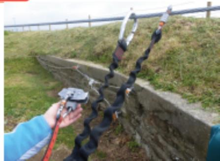
Due cordini dinamici con una corda di colore rosso, munita di un gancio e un moschettone semi-automatico. Un cordino statico con una puleggia e un moschettone semi-automatico. Per l'apertura di questo moschettone, occorre abbassare l'anello arancione e premere con il dito.
