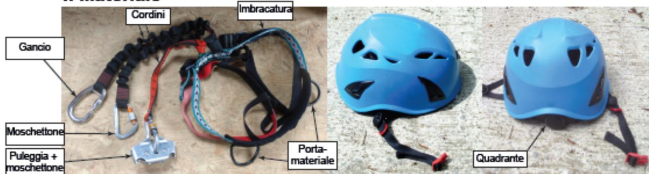
**!** L'imbracatura, equipaggiata di tre cordini e un gancio. Un casco con una molette di regolazione. **Si prega di non aggrapparvi tra di voi tramite il PORTA-MATERIALE. (Resistenza limite di 5 Kg)**
